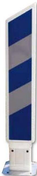
Nos balises J13 permettent la matérialisation des obstacles latéraux qui bordent les chaussées (piles de ponts, entrées de tunnel, murets...). Elles sont rotomoulées en PEHD (polyéthylène haute densité) et sont de conception MONOBLOC. Elles répondent aux exigences de la norme P98-456.
